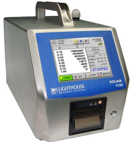
Anstelle des konventionellen HeNe-Lasers verwendet der SOLAIR 1100LD eine IR-Laserdiode. Durch diese innovative Bauart des Sensors entfällt die bei konventionellen Geräten häufige notwendige Reinigung der Messzelle und der gesamte Wartungsaufwand wird auf ein Minimum reduziert.
